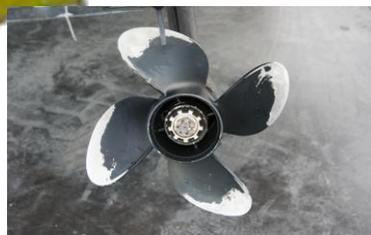
**Palas.-** Piezas de la hélice que transforman el movimiento circular en un empuje.
